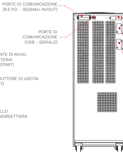
ACTIVE 60 kVA (retro)
